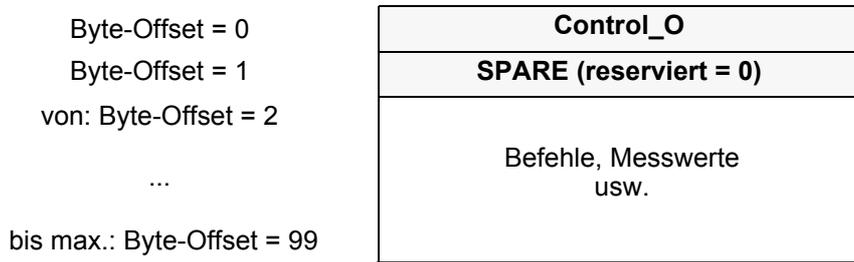
Bild 2-4 Meldeliste: Output-Telegramm mit Handshake-Byte
