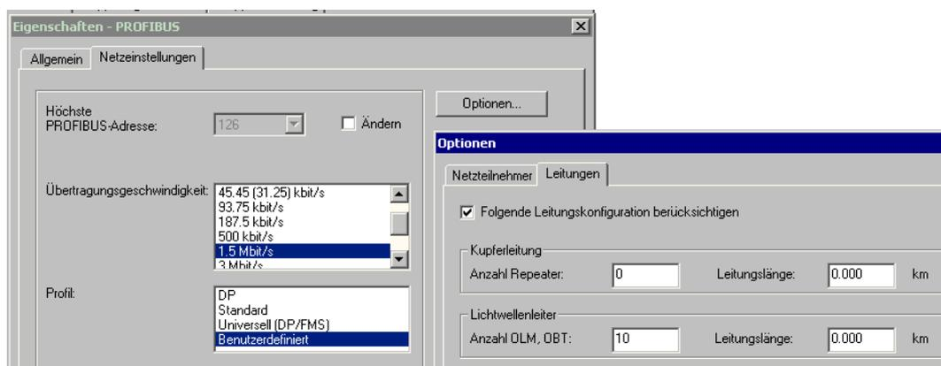
Bild 5-1 PROFIBUS-Parametrierung - Anzahl OLM
