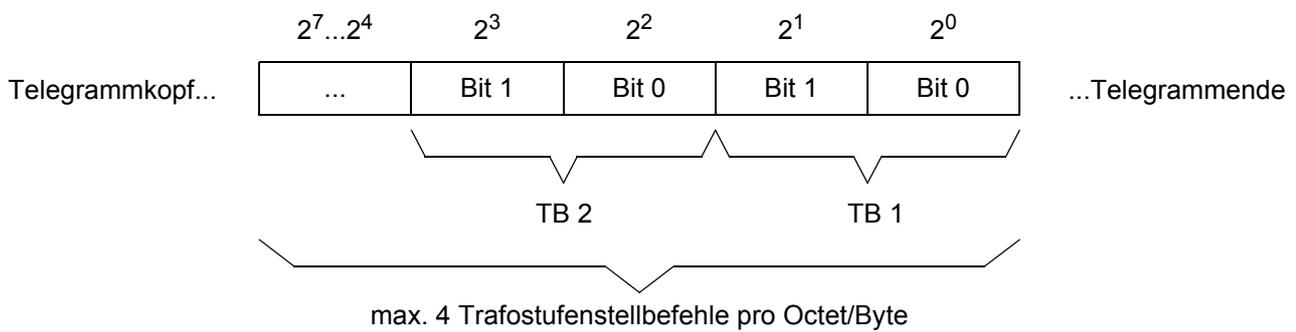
Bild 3-7 Datentyp Trafostufenstellbefehl
