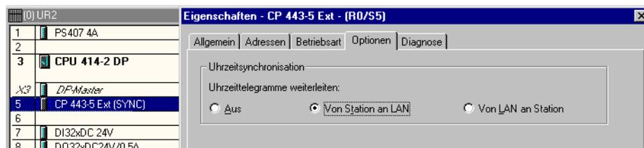
Bild 4-9 CP443-5 Extended - Uhrzeitsynchronisation
