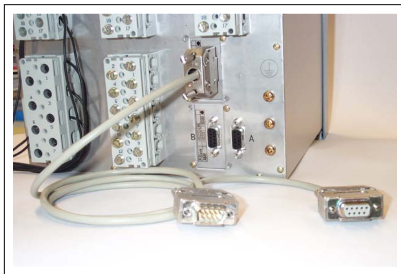
Bild 2: Anschluss an die rückseitige Serviceschnittstelle (Port C )
