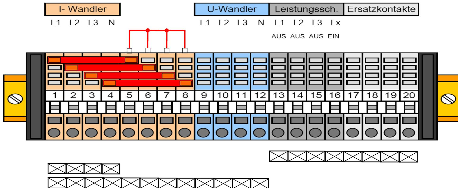
1. Schritt Unterbrechung der Auslösekontakte
