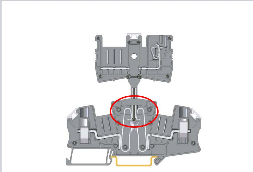
**Erhöhte Sicherheit durch Doppelkontakt!**
