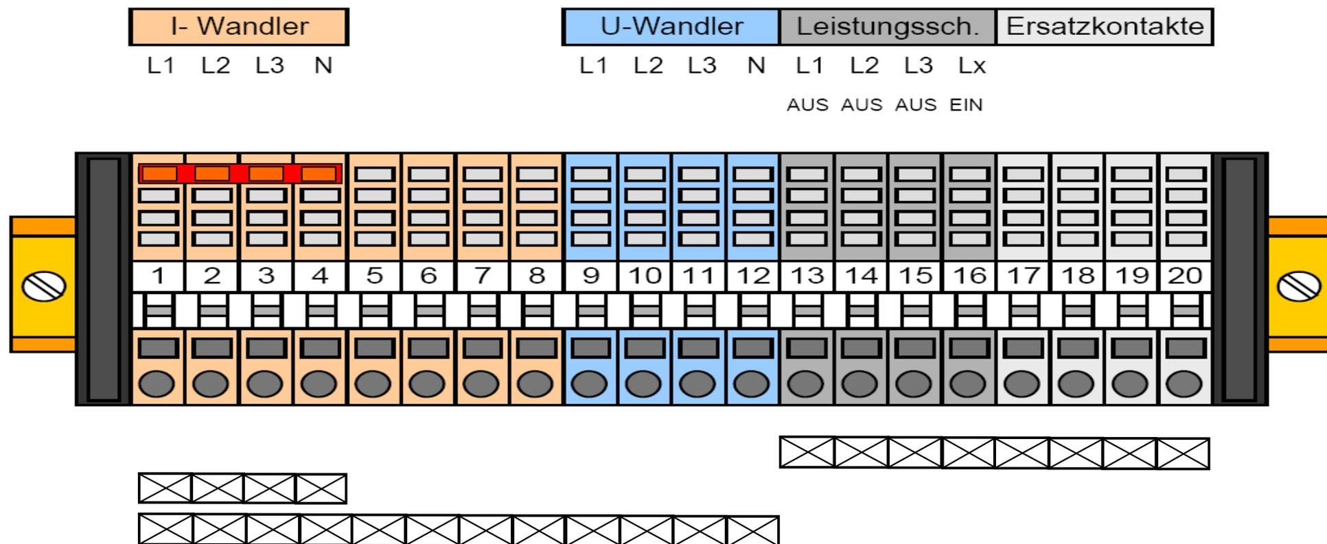
1. Schritt Unterbrechung der Auslösekontakte
