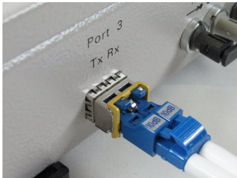
Bild 12 Anschluss des Duplex-LC-Steckers über zwei Dämpfungsglieder an Port 3
