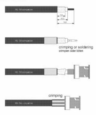
Mounting the BNC-plug with screw technique Montage für BNC-Stecker mit Schraubmontage
