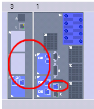
Bild 5-111 Einfügen eines Ethernet-Moduls
