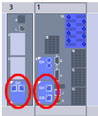
Bild 5-106 Einfügeposition für ein USART-Modul
