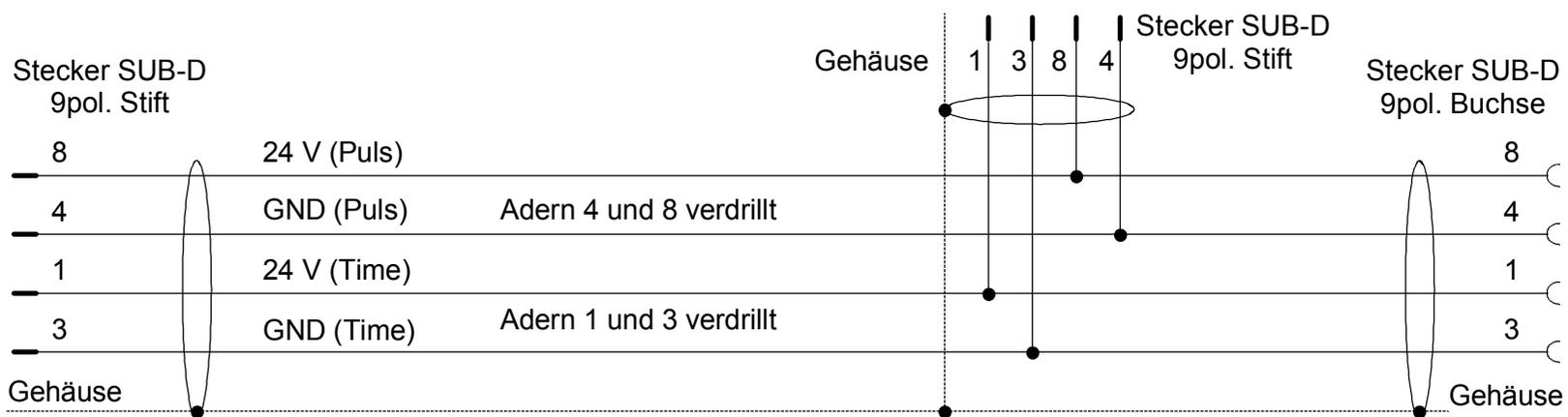
den Schirm an den Gehäusen anschließen
