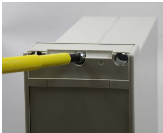
Bild 9-1 Abbau der Frontabdeckung
