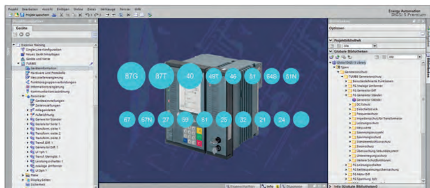
Bild 3. Hohe Flexibilität in Funktionalität durch zusätzlich ladbare Schutzfunktionen
