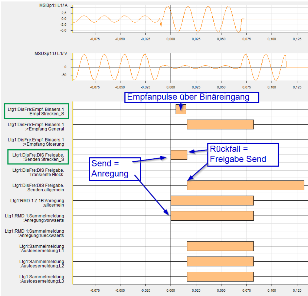
Abbildung 6: Interner Fehler (Distanzschutz- und Z1B-Anregung)
