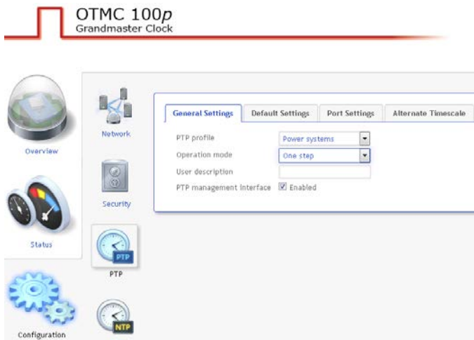
Bild 9: Allgemeine Uhreinstellungen OMICRON Lab OTMC 100p
