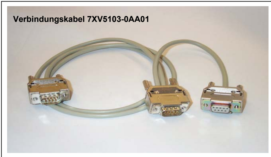
Bild 4: Y-Buskabel für RS485-Bus mit 9-pol. Stecker
