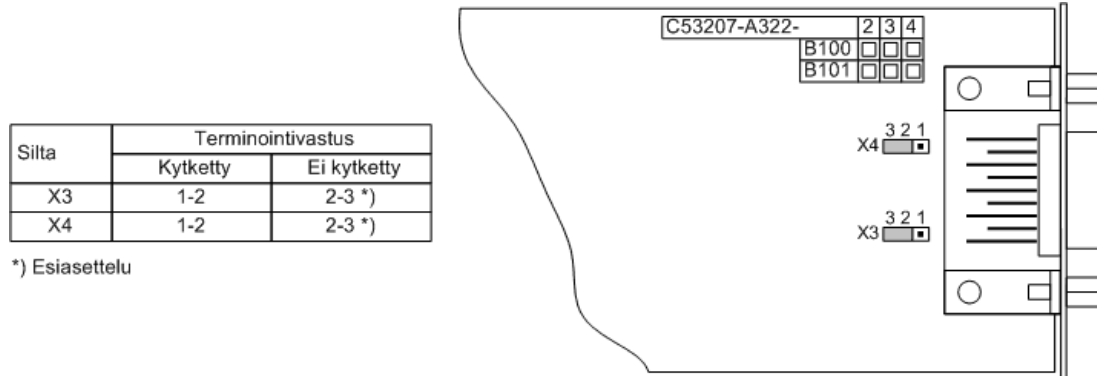
Kuva 3-10 Profibus (FMS ja DP), DNP3.0 sekä Modbus liikennöintiväylien terminointivastusten ja asettelusiltojen asennot
