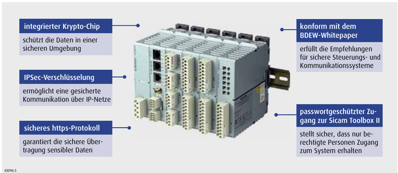
Bild 5. Einige der in RTU zu erwartenden integrierten Sicherheitsmerkmale und -fähigkeiten
