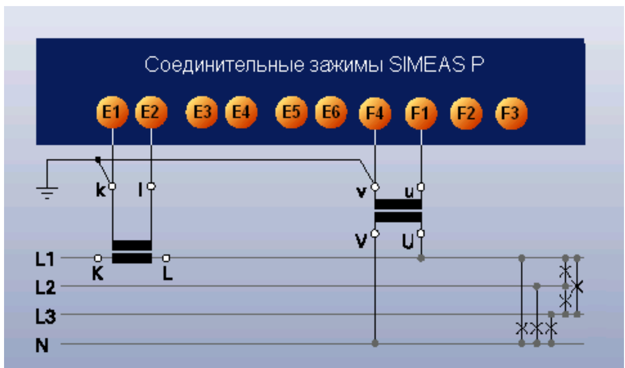
4-проводная 3-фазная сеть с симметричной нагрузкой
