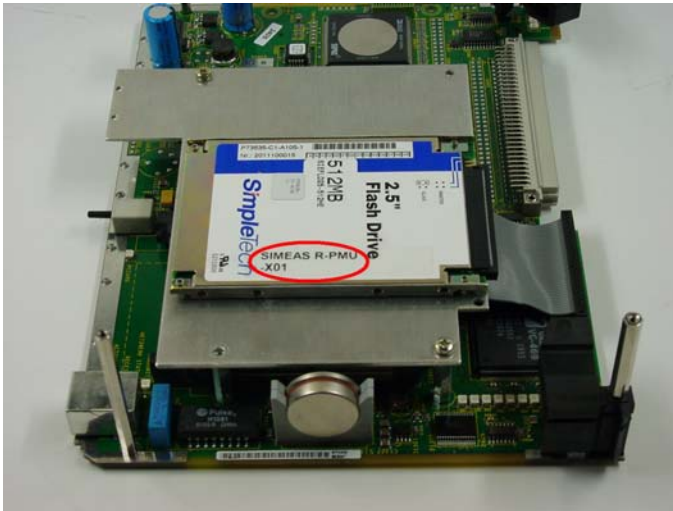
Abbildung 23: Flashdisk auf der CPU-Baugruppe
