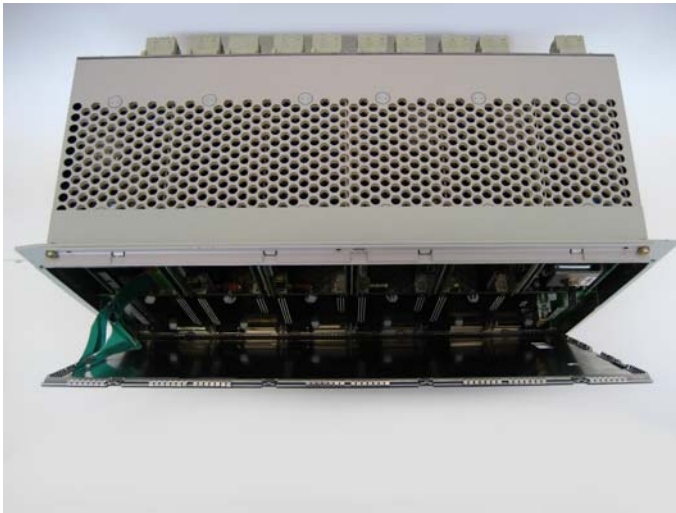
Abbildung 17: Geöffneter SIMEAS R
