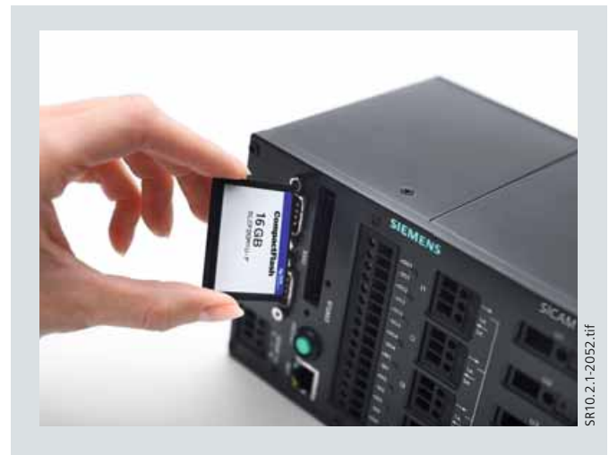
Bild 4/16 Standardausführung: CF-Karte mit 2 GB (erweiterbar bis 16 GB)
