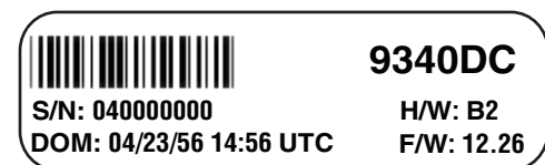
Figura 1: Ejemplo de etiqueta de la central de medida ACCESS 9340 y 9360
