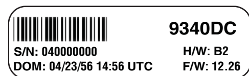
Figure 1 : Exemple d'étiquette sur le compteur ACCESS 9340/9360
