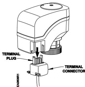
Figure 16. Removing Terminal Plug.
