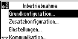
4. Wählen Sie das Untermenü "Grundkonfiguration". Wählen Sie den Anlagentyp/Grundtyp und die Position der Erweiterungsmodul
