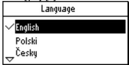
3. Wybierz wymagany język obracając pokrętło nastawcze i zaakceptuj wciskając je. Na wyświetlaczu pojawi się menu "Uruchomienie":
