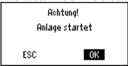
10. Drücken Sie den Drehdruckknopf für OK. Die Anwendung wird gestartet, alle Fühler werden überprüft, vorhandene Fühler werden für spätere Störungsmeldungen markiert. Es erscheint das Hauptmenü:
